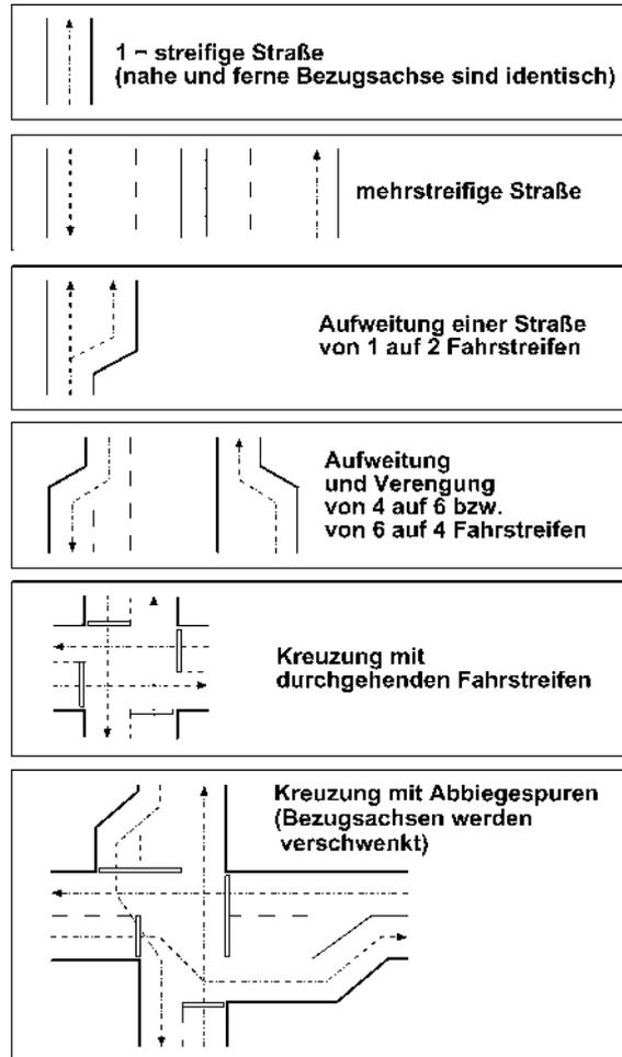
Abbildung 1: Fahrstreifen für die Berechnung des Mittelungspegels
