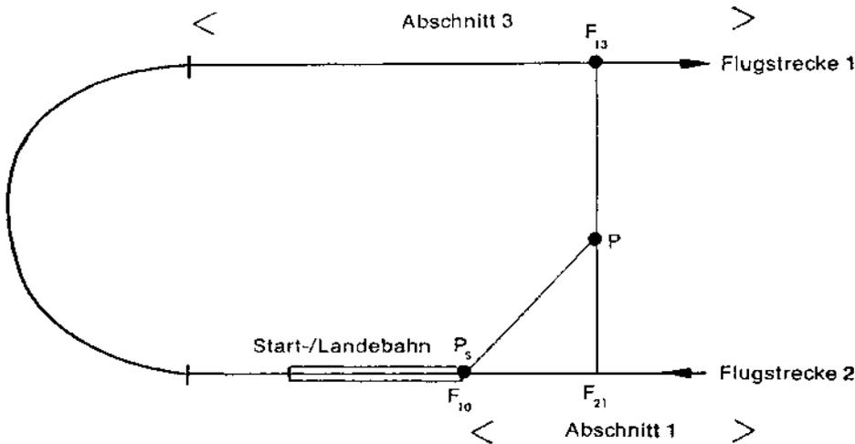
**Abbildung 10:** Lote vom Immissionsort P auf Abschnitt 3 der Flugstrecke 1 (Abflugstrecke) und auf Abschnitt 1 der Flugstrecke 2 (Anflugstrecke) sowie geradlinige Verbindung vom Immissionsort P zum Startpunkt  $P_S$  der Flugstrecke 1. Die Zählung der Abschnitte beginnt unabhängig von der Flugrichtung auf der Start- und Landebahn. Die Pfeile an den Flugstrecken bezeichnen die Zählrichtung.
