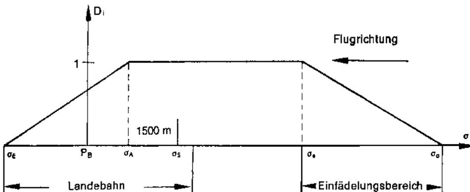
Abbildung 4: Flugzeugdichte  $D_i(\sigma)$  für eine Anflugstrecke,  $P_B$  Bahnbezugspunkt
