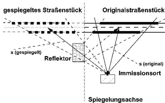
Abbildung 6: Beispiele für die Konstruktion von Spiegelschallquellen
