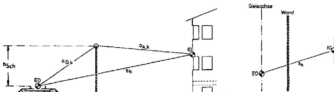
Bild 2: Größen zur Berechnung des Schirmwertes an einer Schallschutzwand
